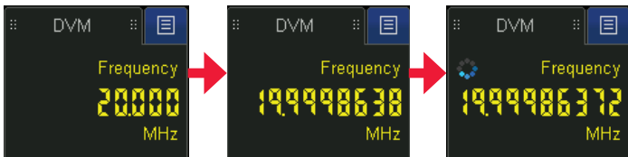
圖 33：精確的 10 位數計數器發現時脈的真實頻率略小於 20 MHz。
