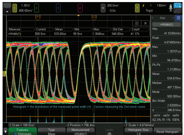
圖 16b：脈衝寬度量測結果繪製成直方圖。
