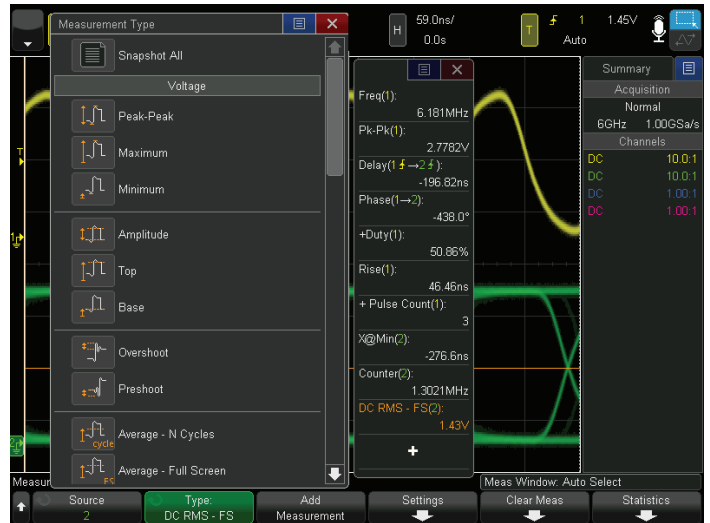
圖 50：量測選擇選單。觸控方式滑動並連點兩次來選擇。
