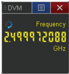
圖 32：10 位數計數器對 2.5 GHz 信號進行精確的頻率量測。
