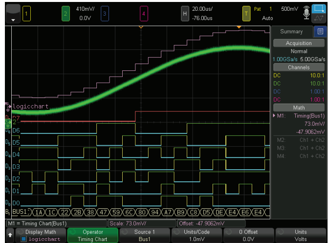
圖 26：使用邏輯時序圖功能同時顯示類比和數位信號。
