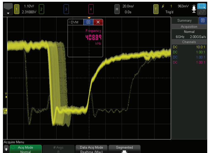
圖 10：6000 X 系列的超快波形更新速率可發現罕見突波。
