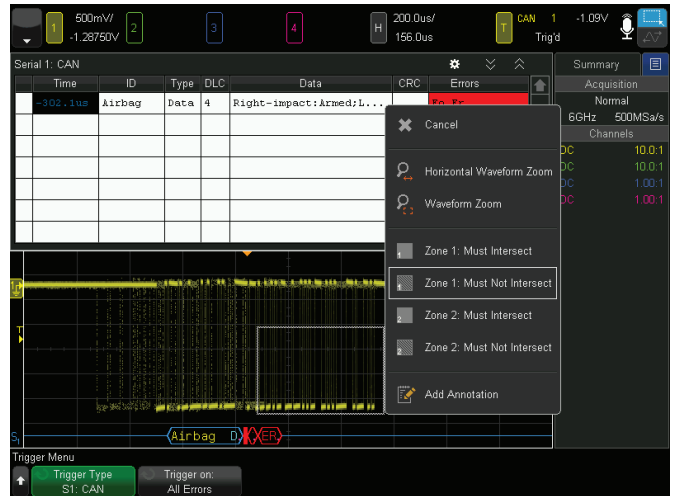
圖 13：為 CAN 匯流排錯誤封包觸發加設一個區域觸發。
