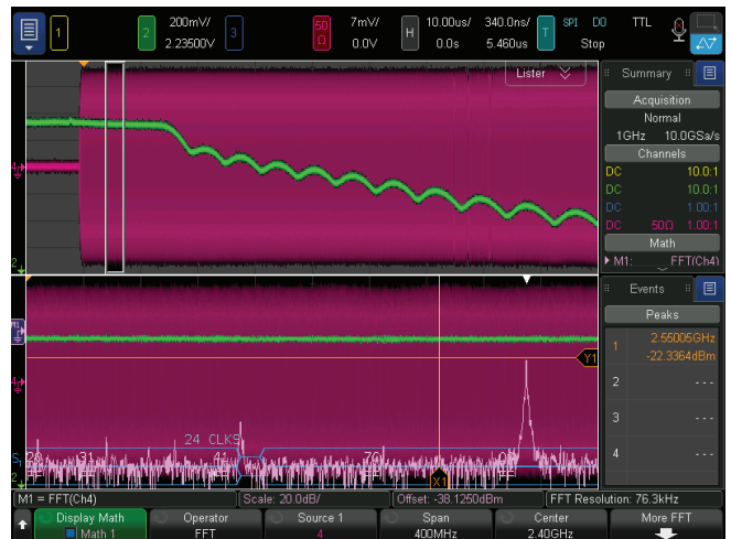
圖 37a：閘控 FFT 在給定時距內與 PLL 電壓、SPI 指令及頻譜內容的關聯。
