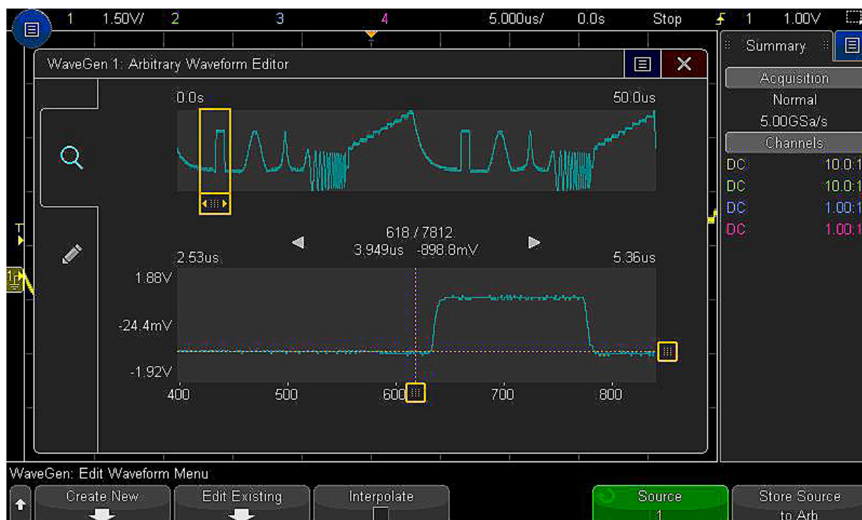
圖 29：標配的任意波形產生器讓您能輕鬆存取激發變量。整合式任意波形產生器讓信號擷取、修改和播放變得更簡單了。
