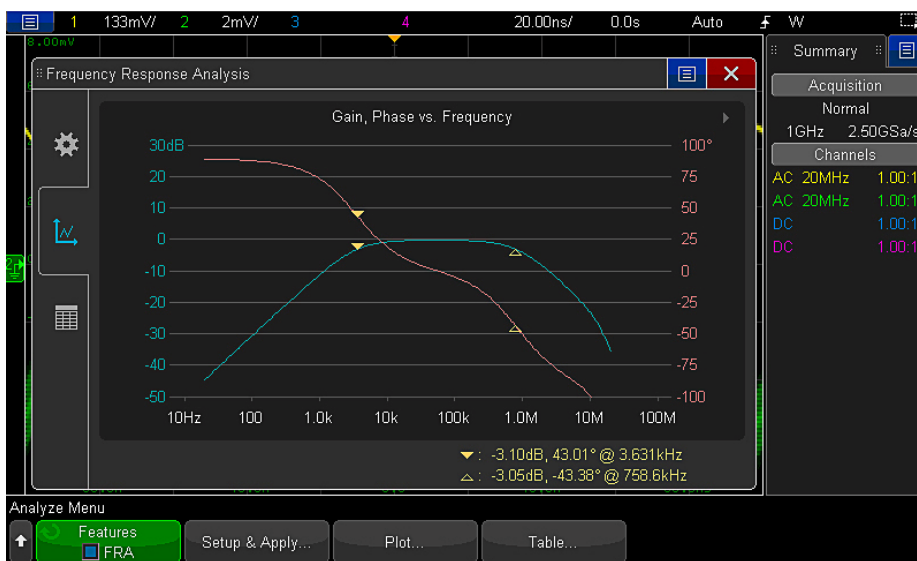
圖 28：帶通濾波器的頻率響應分析圖 ( 波特增益和相位 )。
