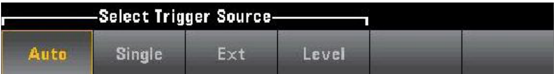
圖 4：34465A/34470A DMM 搭載進階觸發模式
